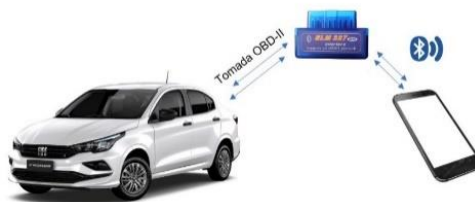
Figura 3 - Conexão entre o veículo, o aparelho de coleta de dados OBD-II e o smartphone
