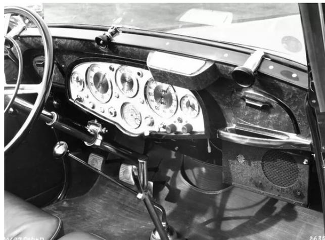
Figura 2.2: Ilustração da instalação do rádio automotivo.
