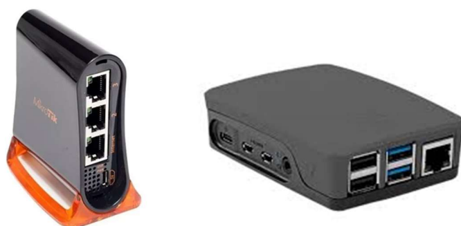
Figura 2 - Mikrotik HAP Mini (esquerda) e Raspberry Pi (direita), ambos com medida aproximada de 3 polegadas de dimensão diagonal. Fonte: Mikrotik e Raspberry Pi .
